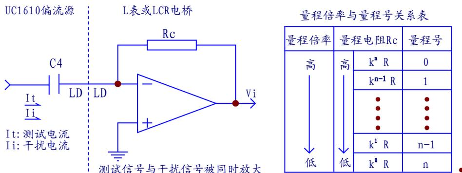
因此, 对于高阻抗电感器, 本机的适用性受到一定的限制, 这也是前述存在电感频率曲线限制的原因。
