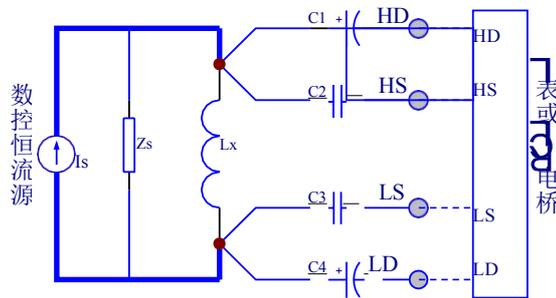
由图可见 UC1610 采用四端叠加测试，完整地保留了 L 表及 LCR 电桥的四端测试原理，这是 UC1610 在宽频范围内具有较高测试精度的基础。
