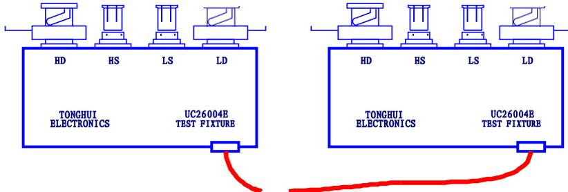
2) 测试夹 UC26004F：用于联接被测件
